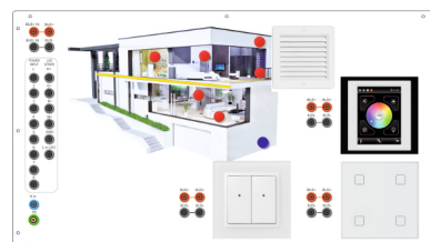
Panel UV-140, INELS chytrá domácnost - DŮM, demonstrační panel elektrických ovládacích prvků a spotřebičů v domě.
